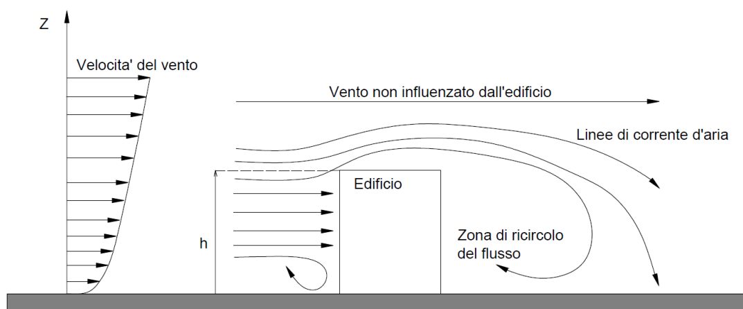
Figura 8: profilo di velocità del vento ed influenza dell'edificio.
